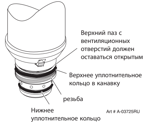
Уплотнительное кольцо головки горелки
