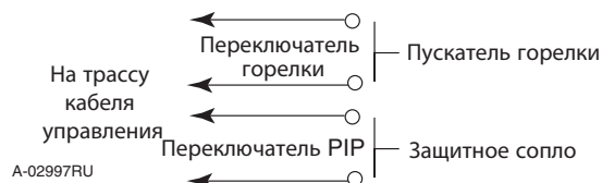
Схема цепи «детали на месте» для ручной горелки
